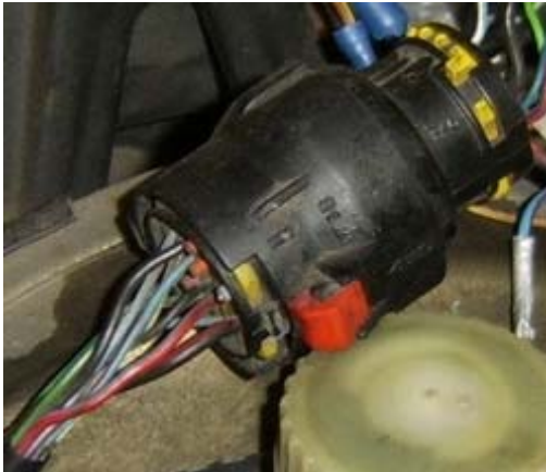
Stecker X5 – Kadett E C14NZ und C20XE (Motorraum)
